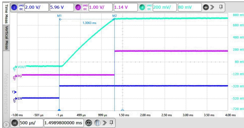
10.启动波形曲线： V_{OUT}=0.8V ，使能电压 0V\sim 2V 跳变时，输出电压启动波形及电源正常引脚状态波形。
